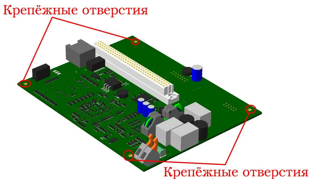
Рис.6 Места установки винтов для крепления АЛС-АУ в корпусе
