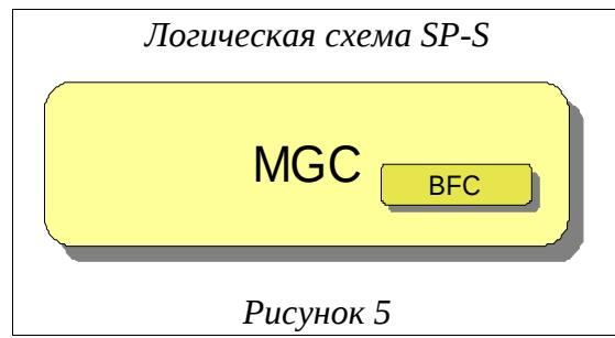
Основное предназначение MGC прием и разбор сигнализаций про протоколу SIGTRAN, связь с SP-S и отдача команды MG.
